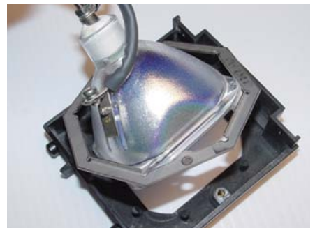
Cerabond™ 835-M bonds halogen lamp.
